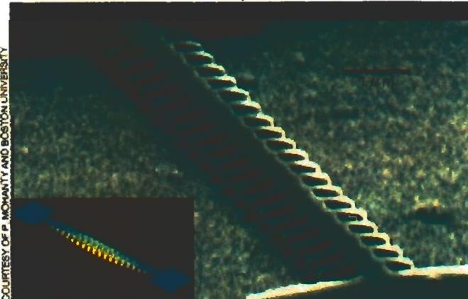
たわむシリコンの梁（棒（くし））の歯に似た多数の突起がついたこの棒は、約500億個のシリコン原子でできている。コンピューターシミュレーションによると、繰り返し振動する力を加えると曲がり（挿入図）。機械式量子ビットを実現できる可能性がある。ボストン大学の研究者が試作。
