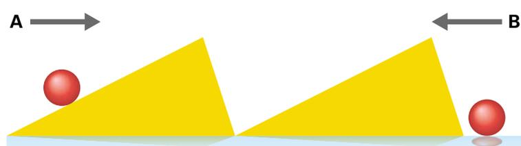
ボールはAの方向には動かしやすいが、反対のBの方向には、急な上り坂があるため動かしにくい。
